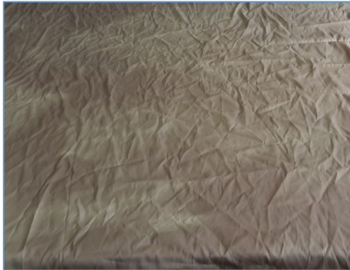
Abb. 1: Polyester-Stoff nach einem normalen Waschvorgang
