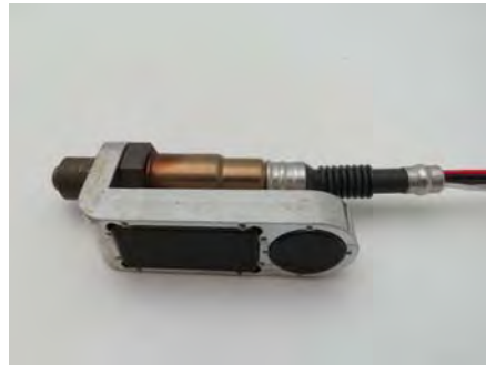
Abb.: Magnetische Sondenhalterung mit Sonde
