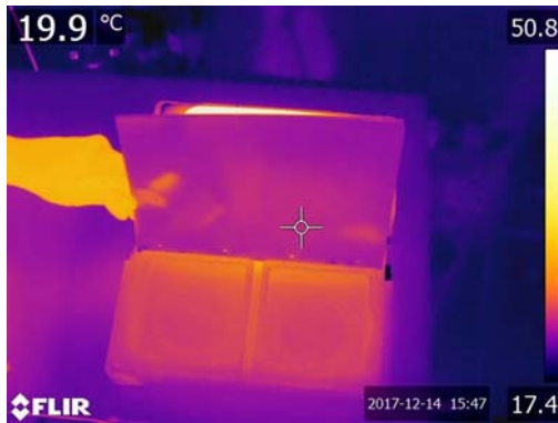
Aufnahme Thermobox Warmbefüllung nach 30 min innen
