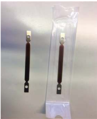
Aktuelle Situation: Prüfung der Hygieneleistung: Edelstahlprüfkörper
