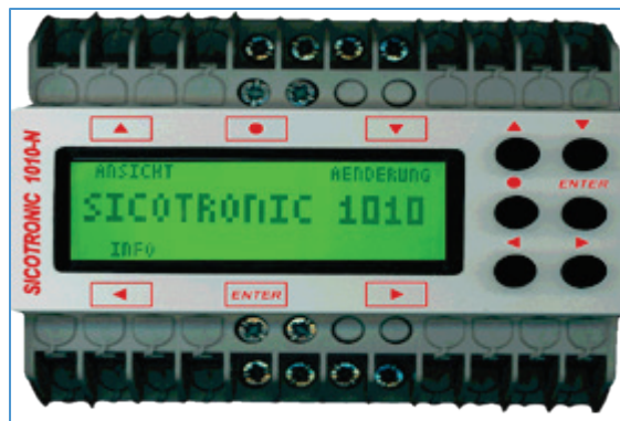
Abb. 1.21: Anzeige- und Bedienmodul ABM 1010 für Local Operating Network (LON)-Bus-Technik (Bild: Sicotronic GmbH)
