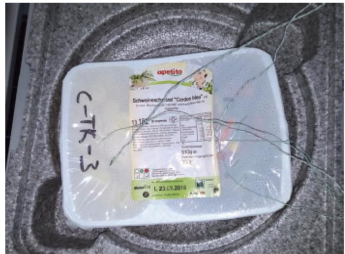
Abb 1: Messanordnung für die Messung des Kerntemperaturverlaufs der einzelnen Komponenten. Foto schlemmerpiloten
