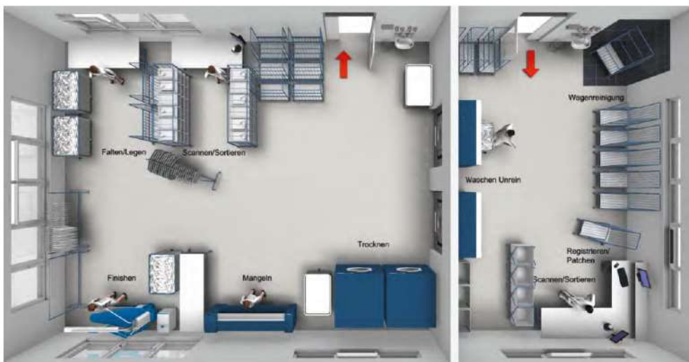
Abb. 2: Bauliche, apparative und personale Trennung von unreiner Seite (rechts) und reiner Seite (links im Bild) (Quelle: Miele Professional)
