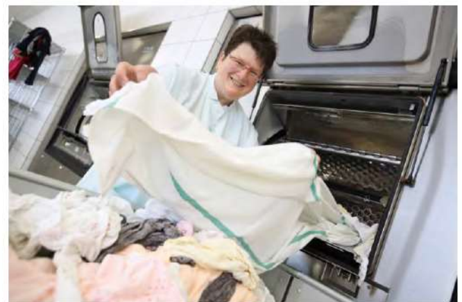
Abb. 3: Trennwandmaschine beim Entladen auf der reinen Seite (Quelle: Miele Professional)
