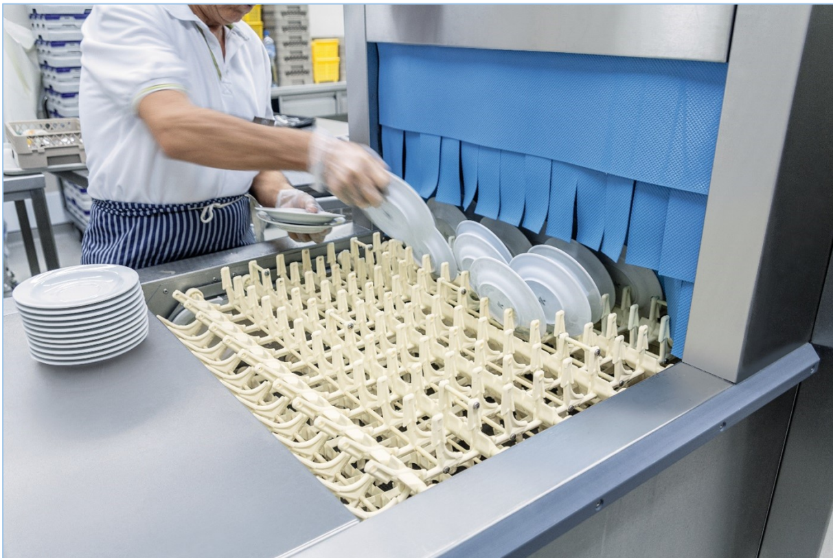
Abb. 44: Fingerband einer Bandtransportspülmaschine (© Meiko Maschinenbau GmbH & Co. KG, Offenburg)
