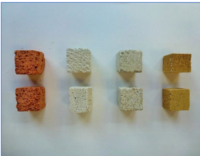
Abb. 2: Würfel der Kantenlänge ca. 20 mm aus den Werkstoffen Hipor, Porenbeton, Kalksandstein und Cordierit (von links nach rechts, Teilprojekt 2)
