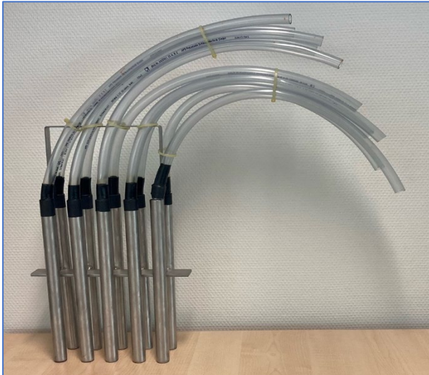
Abb. 1: Verdampferkonstrukt (Variante 1) aus einseitig verschlossenen Edelstahlrohren (Nachbau MKN von Teilprojekt 1, Foto Fritz Kropholler)
